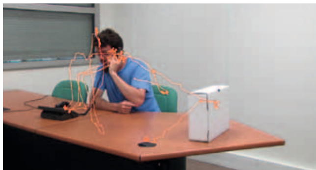
Рис. 1. Пример карты записи движения глаз; оранжевая кривая отражает траекторию движения глаз в процессе рассматривания кадра на протяжении некоторого промежутка времени
