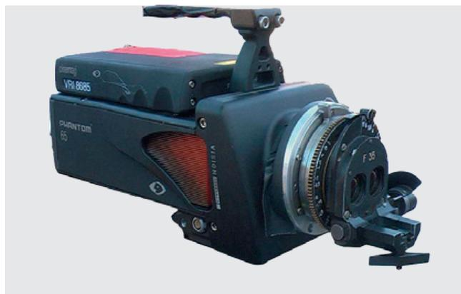
**Камера PHANTOM с объективами Стерео-70**
