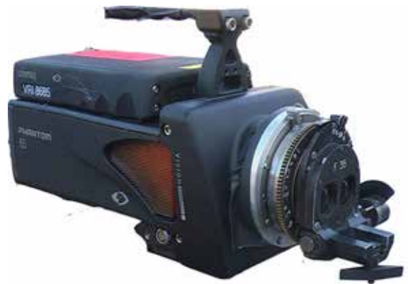
Фото 3 цифровой рекордер «Phantom 65» с объективом «Стерео-70»
