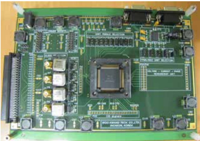
Рис. 13. Тестовая система контроля (макетная плата) микропроцессоров и экспериментальный многофункциональный микропроцессор, пригодный для перспективных нейронных сетей.
