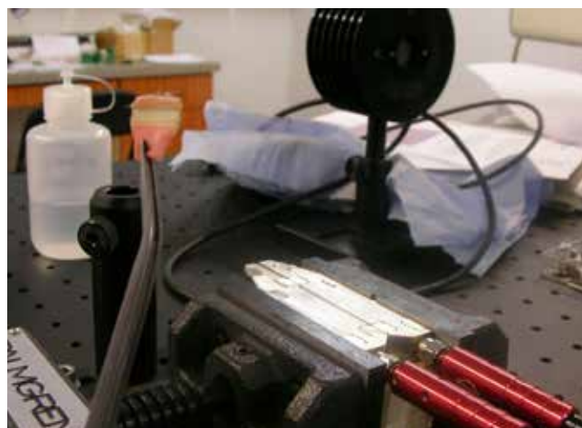
Рис. 4. Комплексный элемент фотоники высокой мощности, разработанный автором для лазерной сварки кровеносных сосудов и прочих применений, по заказу компании Vigitek Inc. (США).
